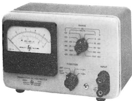
Un voltmetro ac di impiego generale, atto a funzionare nella banda da 1 Hz a 1 MHz, completamente transistorizzato e munito di una batteria per 400 ore di funzionamento, è stato recentemente presentato dalla HEWLETT-PACKARD Co. E' il mod. 403A. Misura tensioni tra 1 mV f.s. e 300 V f.s. con una incertezza del + 3% tra 5 Hz e 500 kHz e del + 5% tra 1 e 5 Hz e tra 0,5 e 1 MHz.
