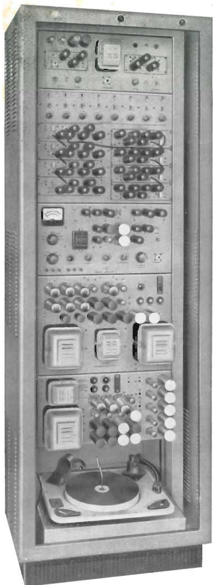
GENERATORE DI 8 CANALI TV MOD. 656 - RF
