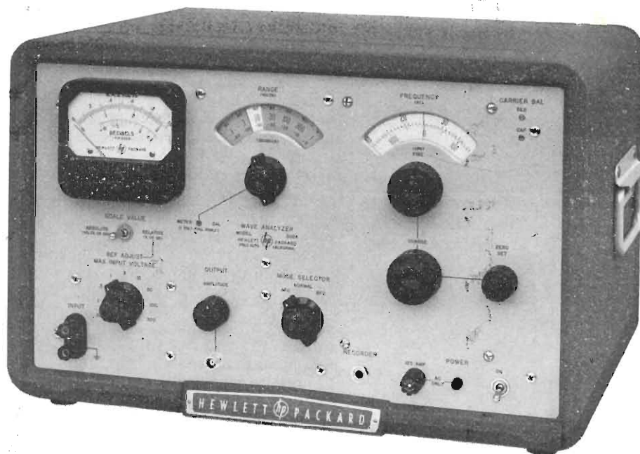
Fig. 1 - Aspetto frontale dell'analizzatore transistorizzato, mod. 302A.
